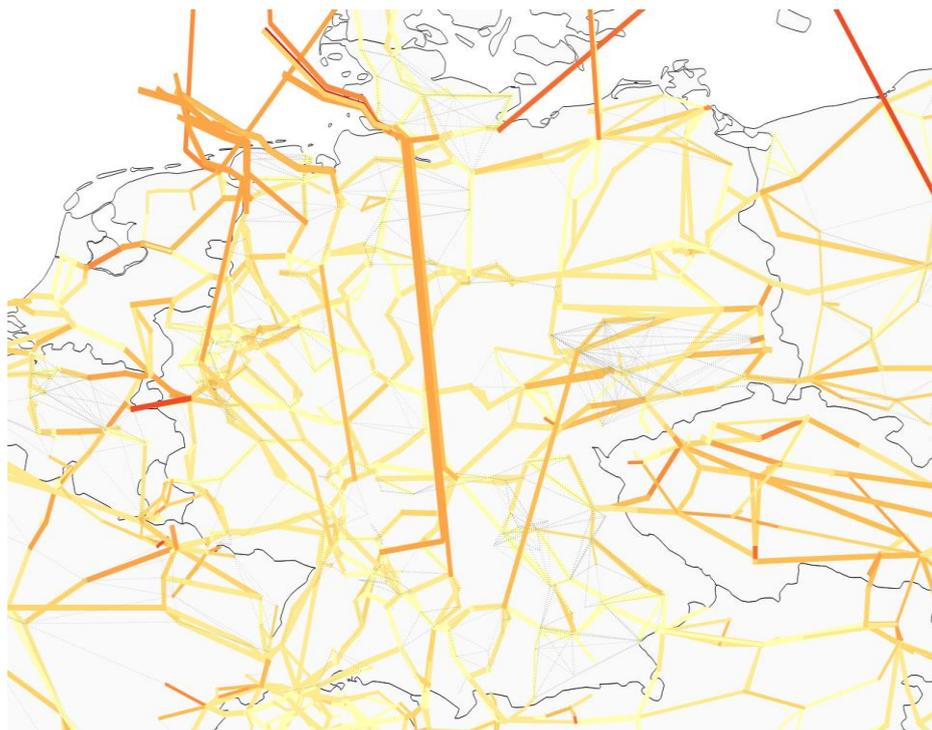
Abbildung 14: Mittlere Auslastung des Zielnetzes nach IFHT-Simulationen
