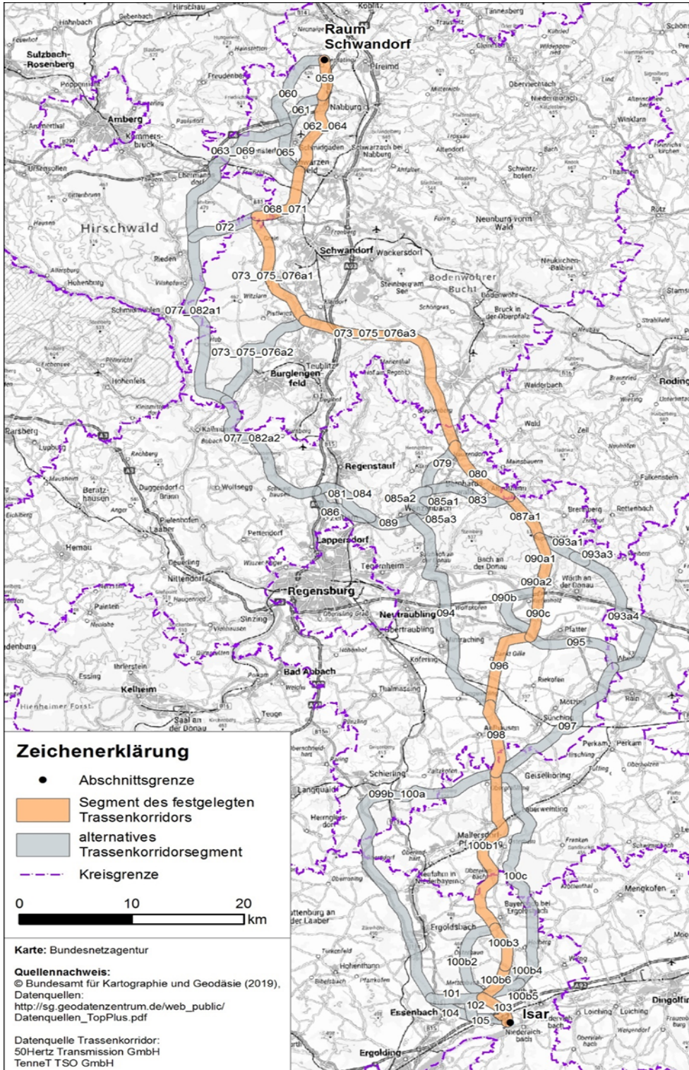
Abbildung 1: In der Bundesfachplanungsentscheidung festgelegter Trassenkorridor
