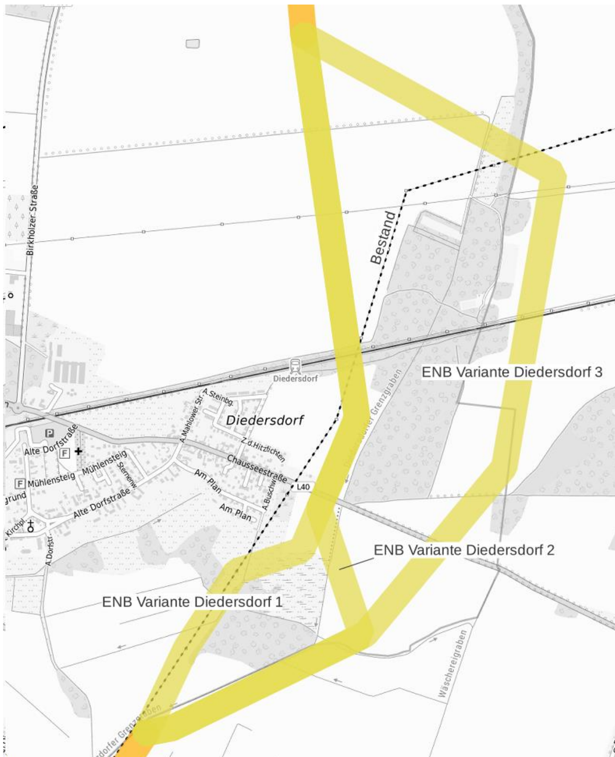
Abbildung 3-3: Übersicht Trassenvarianten bei Diedersdorf
