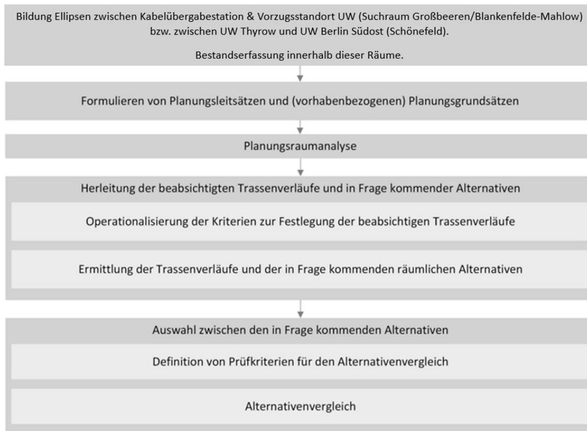
Abbildung 3-1: Ablaufschema zur Herleitung des beabsichtigten Trassenverlaufes
